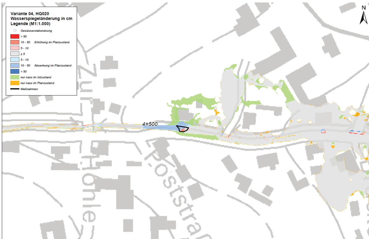
Abbildung 7.22: Wirksamkeit eines Umbaus der Brücke Nr. 34 bei km 4+469, HQ20 – nicht maßstäblich (Betrachtung von Hochwasser, nicht Starkregen)
