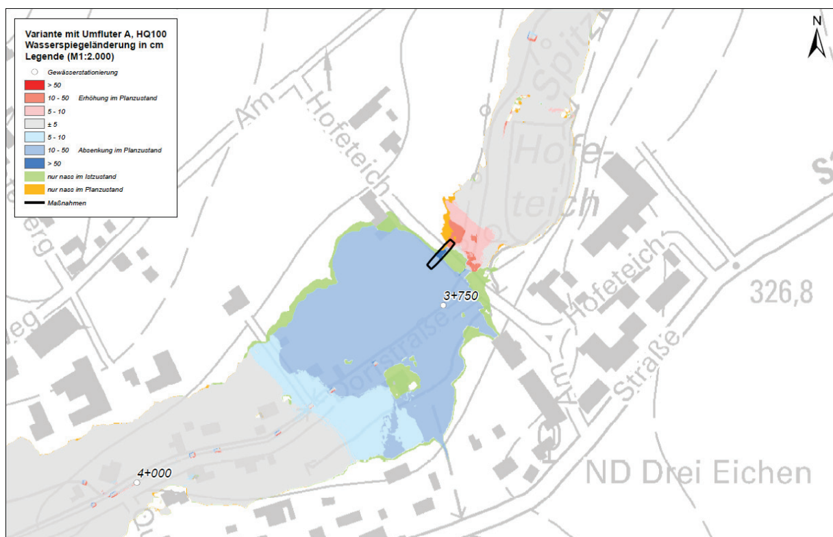
Abbildung 7.12: Wirksamkeit der Umflut Variante A, HQ100 – nicht maßstäblich (Betrachtung von Hochwasser, nicht Starkregen)
